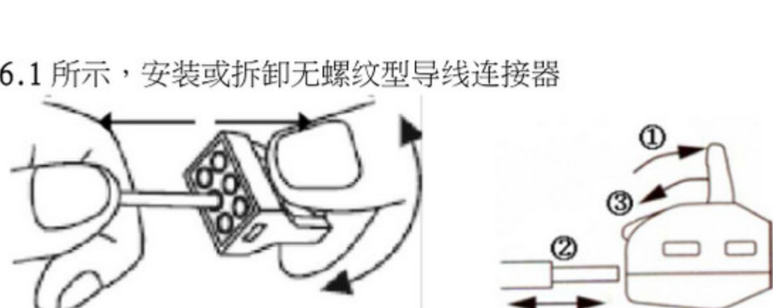
图 6.1 A 推线式连接器的导线安装或拆卸示意图
